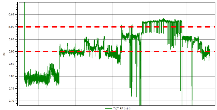
Gráfica 1.1 Factor de potencia en el transformador principal.
